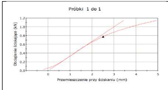
Figura 15. Curba CBR- pământ stabilizat cu zgură metalurgică
