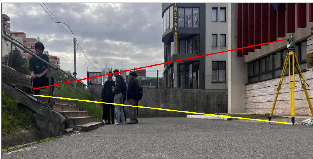
Figura 11. Realizarea măsurătorilor cu miniprisma
