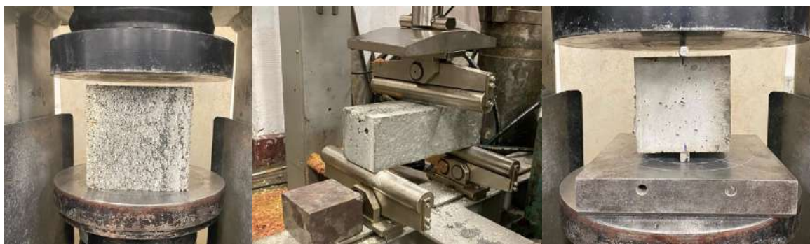
Figura 7. Poze cu încercările de compresiune, întindere prin încovoiere și întindere prin despicare (de la stânga la dreapta) cu metoda 1 de testare
