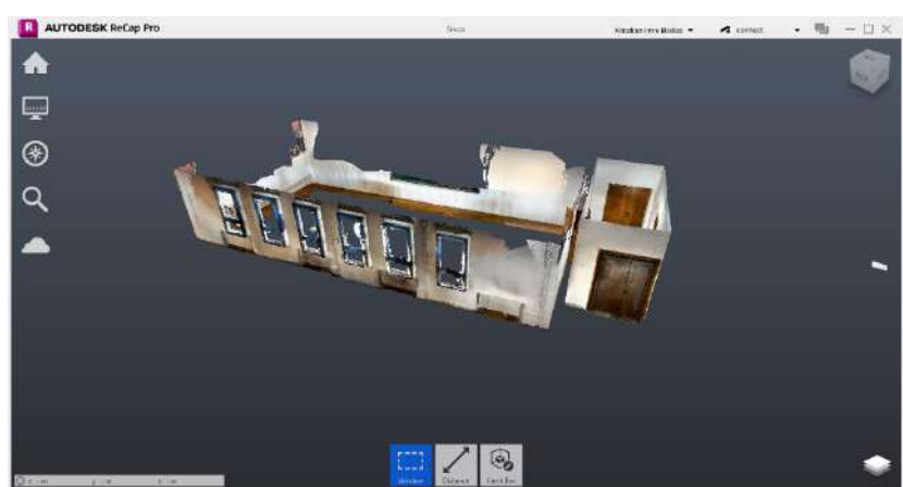
Figura 53-Norul de puncte în ReCap
