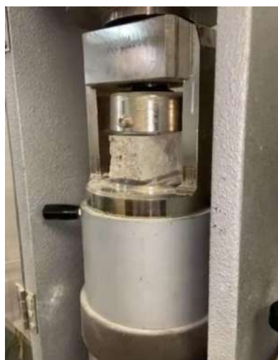
Fig. 4. Determinarea rezistenței la compresiune utilizând presa hidraulică
