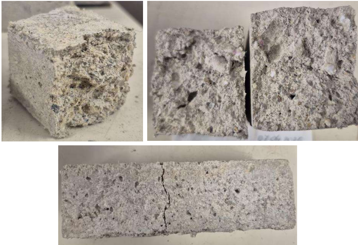
Figura 7. Aspectul secțiunii transversale și evidențierea porozității matricei la 28 de zile
