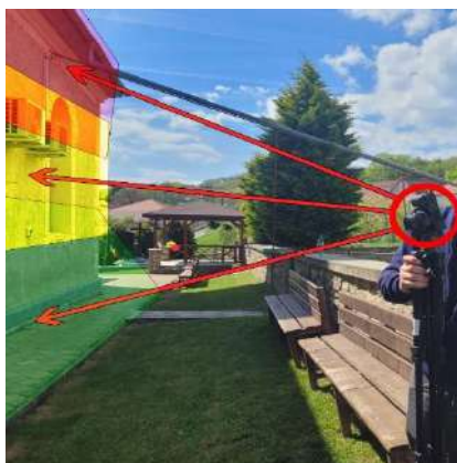
Figura 7. Moduri de preluare a fotogramelor de la sol.
