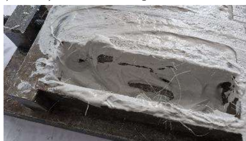
Figura 19. Turnarea primului strat de ipsos
