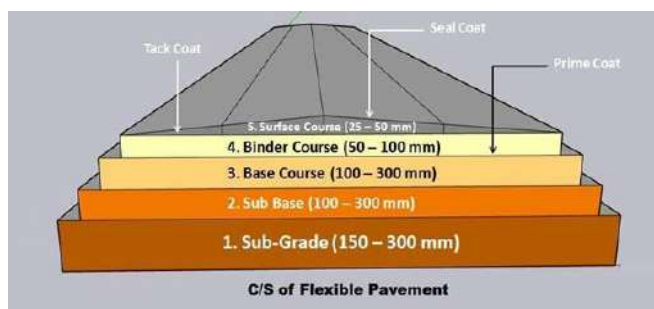
Figura 13. Principiul de dimensionare a structurilor rutiere flexibile pe baza indicelui CBR
