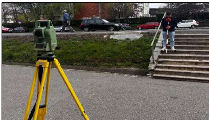
Figura 12. Realizarea măsurătorilor cu prisma mare
