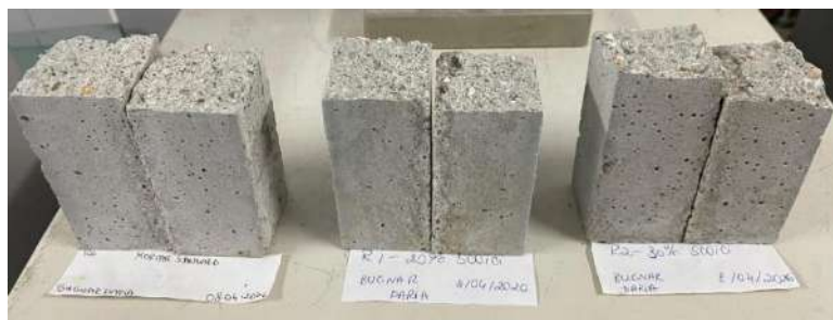
Fig. 5. Epruvete din mortar după încercarea experimentală la încovoiere
