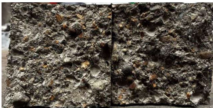
Figura 5. Distribuția de fibre metalice și polipropilenă pe secțiunea transversală a betonului consolidat
