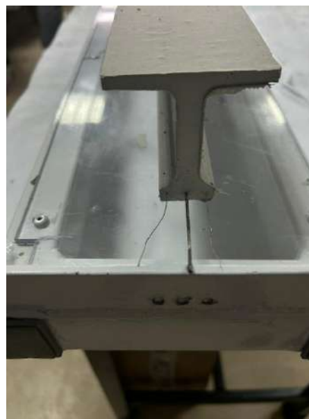
Figura 8. Cablu pretensionat și fire pentru testarea tensiunii
