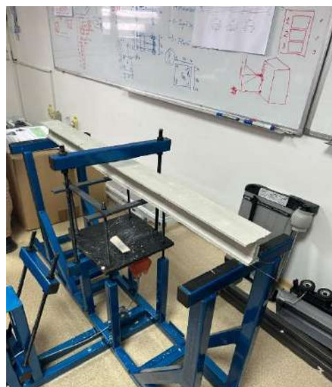
Fig. 12. Grinda pregătită de testare în momentul alegerii firului care va fi introdus în grindă
