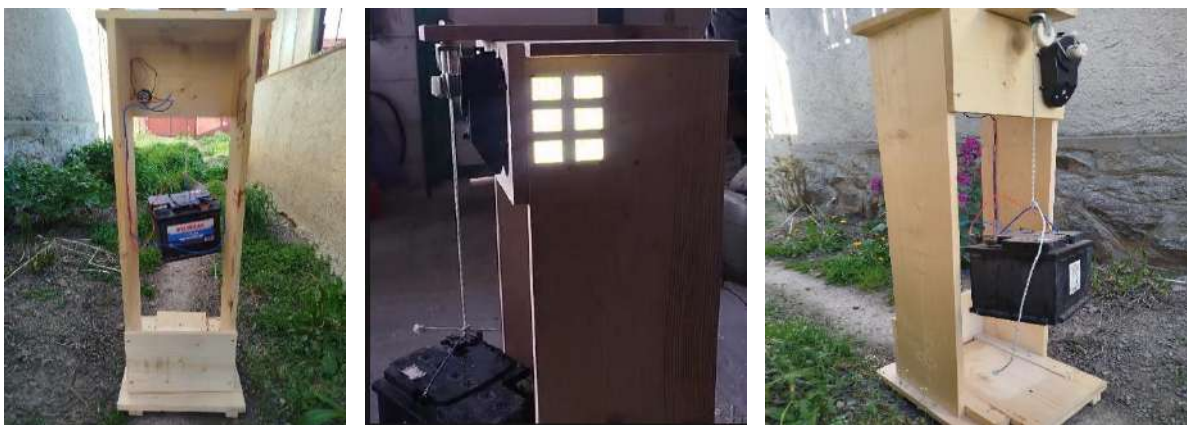
Figura 6. Mini-prototip Baterie Gravitațională.
