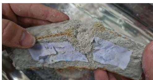
Figura 38. Probă din G2 supusă la întindere
