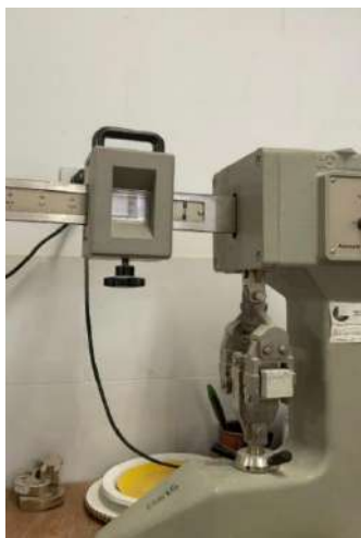
Fig. 3. Determinarea rezistenței la încovoiere utilizând aparatul Fruhling-Michaelis
