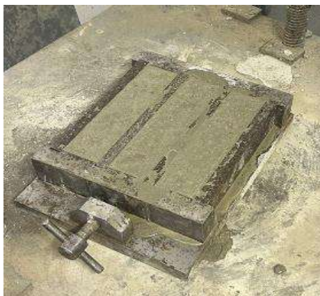
Fig. 2. Prepararea și turnarea epruvetelor prismatice din mortar
