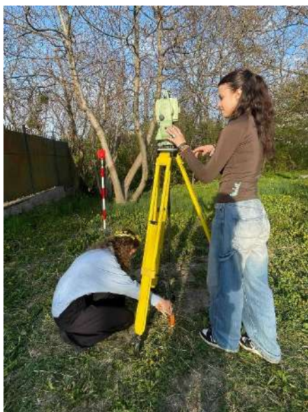
Fig.4. Calarea și măsurarea înălțimii aparatului.
