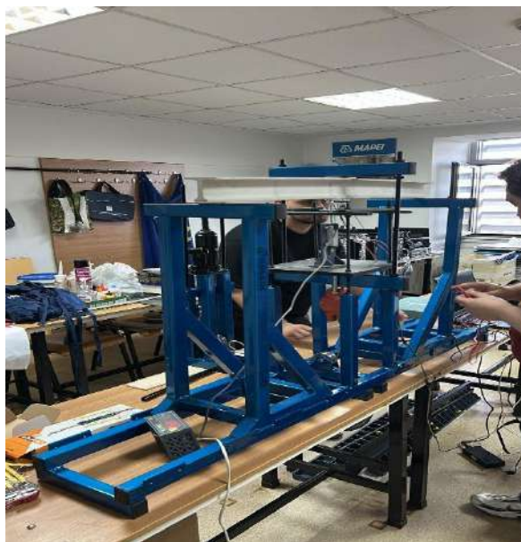
Figura 1. Imagine cu grindă pe bancul de testare
