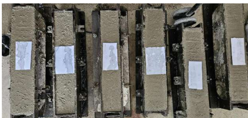
Figura 2. Epruvetele rezultate în urma turnării betonului proaspăt și textura betonului consolidat
