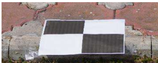
Figura 3. Țintă fotogrammetrică utilizată.
