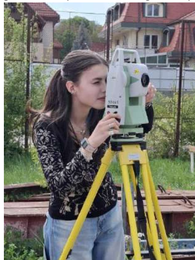
Fig. 10. Vizarea punctelor de detaliu cu stația TS02 plus.
