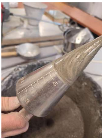
Fig. 2: Determinarea consistenței cu conul gradat.
