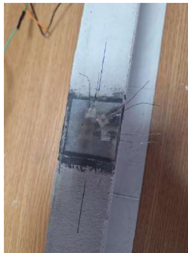
Figura 2. Încercare pe mărci tensiometrice din hârtie.
