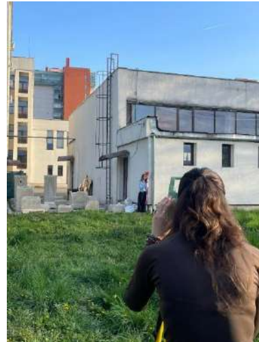
Fig. 7. Vizarea punctelor de detaliu cu stația TC405.
