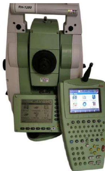
Figura 2. Stația totală Leica TCRP 1201
