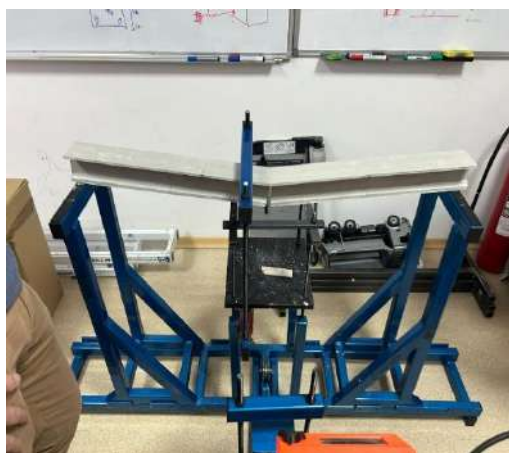
Figura 9. Cedare grindă în urma testării
