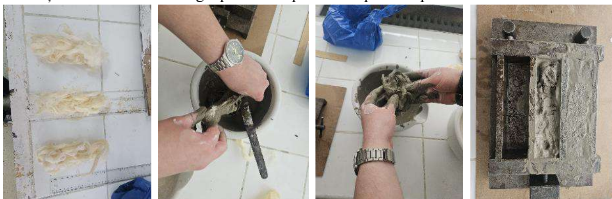
Figura 10. Dozarea fibrelor Figurile 11 și 12. Despărțirea fracțiunilor aglomerate Figura 13. Turnarea în tipar
