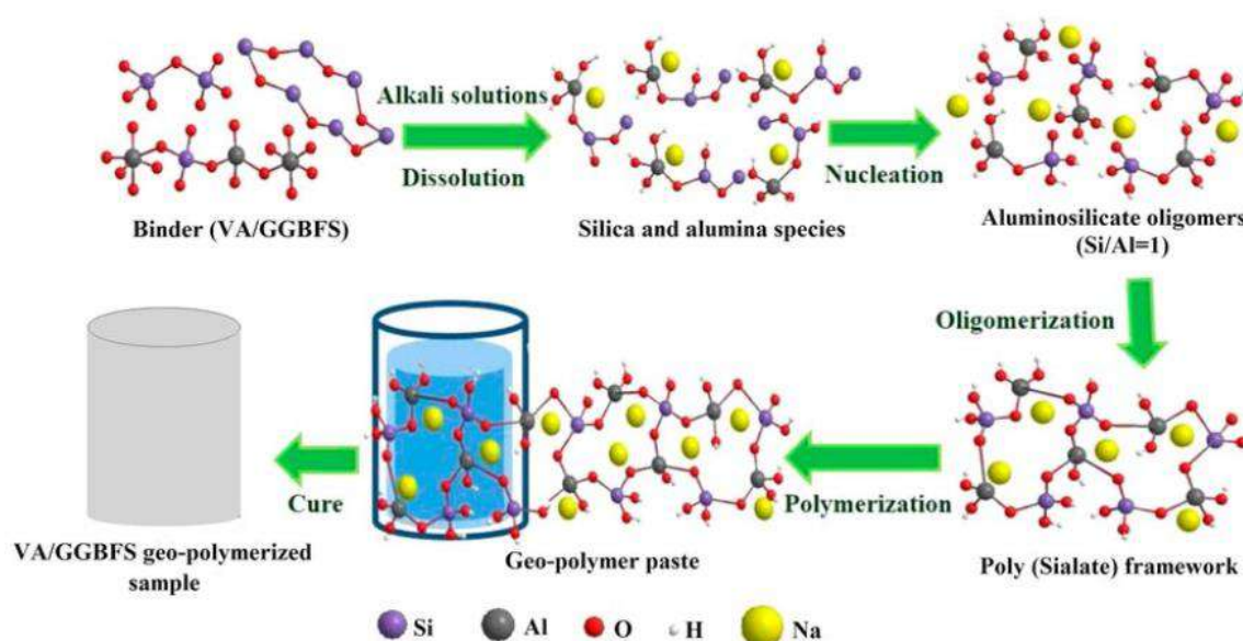
Figura 1. Reprezentarea schematică a procesului de geopolimerizare
