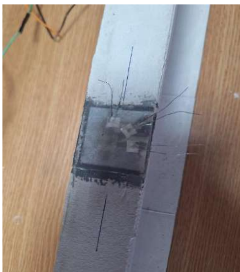
Fig. 13. Încercare pe mărci tensiometrice din hârtie
