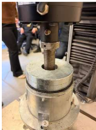
Figura 5. Penetrarea pistonului CBR
