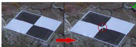
Figura 9. Marcarea punctelor cunoscute pe fotograme.
