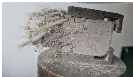
Figura 39. Epruvetă solicitată la compresiune pentru G2
