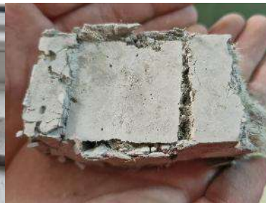
Figura 32. Epruvetă din G1 supusă compresiunii
