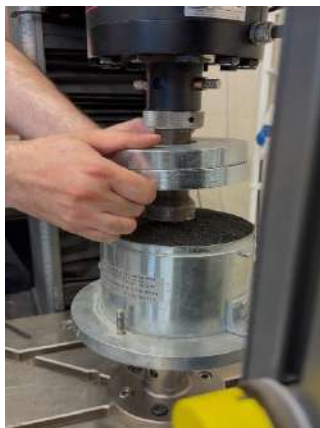
Figura 4. Poziționarea inelelor de supraincercare
