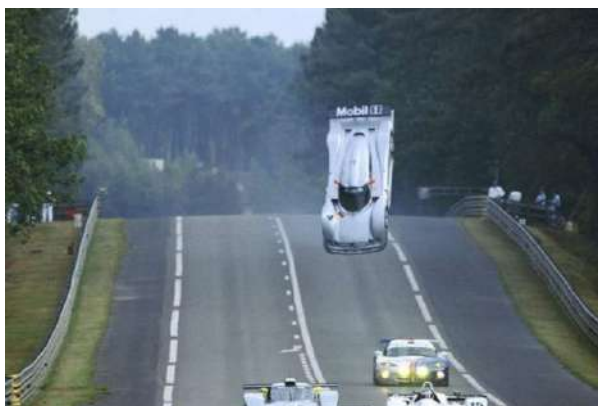
Figura 9. Influența racordării verticale asupra stabilității la viteze mari (Le Mans 1999).[10]
