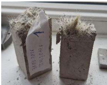
Figura 31. Modul de rupere al probelor Grupului G1
