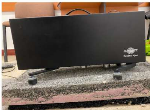
Figura 9. Testarea acustică a probelor cu ciocanul de impact
