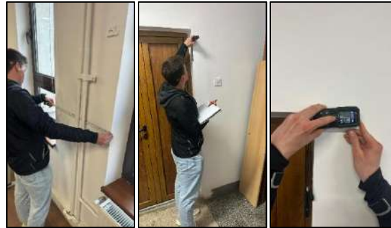
Figura 44- Măsurătorile cu ruletă clasică și telemetru
