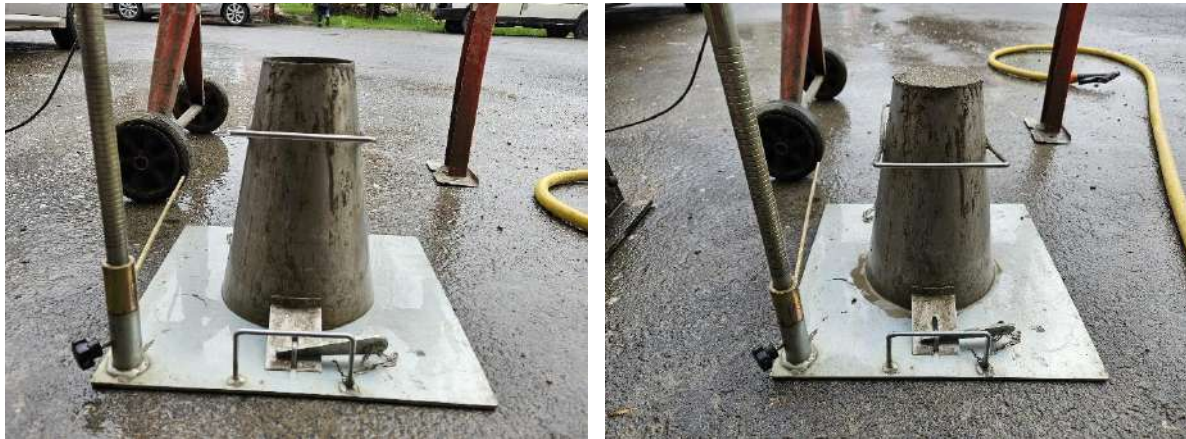
Figura 3. Determinarea consistenței betonului proaspăt utilizând metoda cu conul
