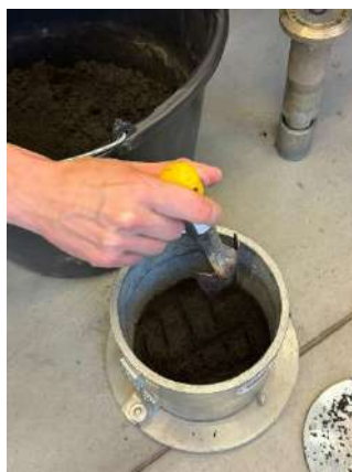
Figura 2. Scarificarea stratului compactat
