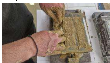
Figurile 24, 25, 26. Introducerea în tipar a amestecului
