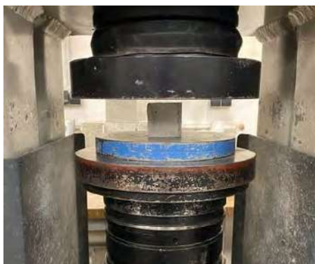
Figura 5. Încercarea betonului simplu la compresiune
