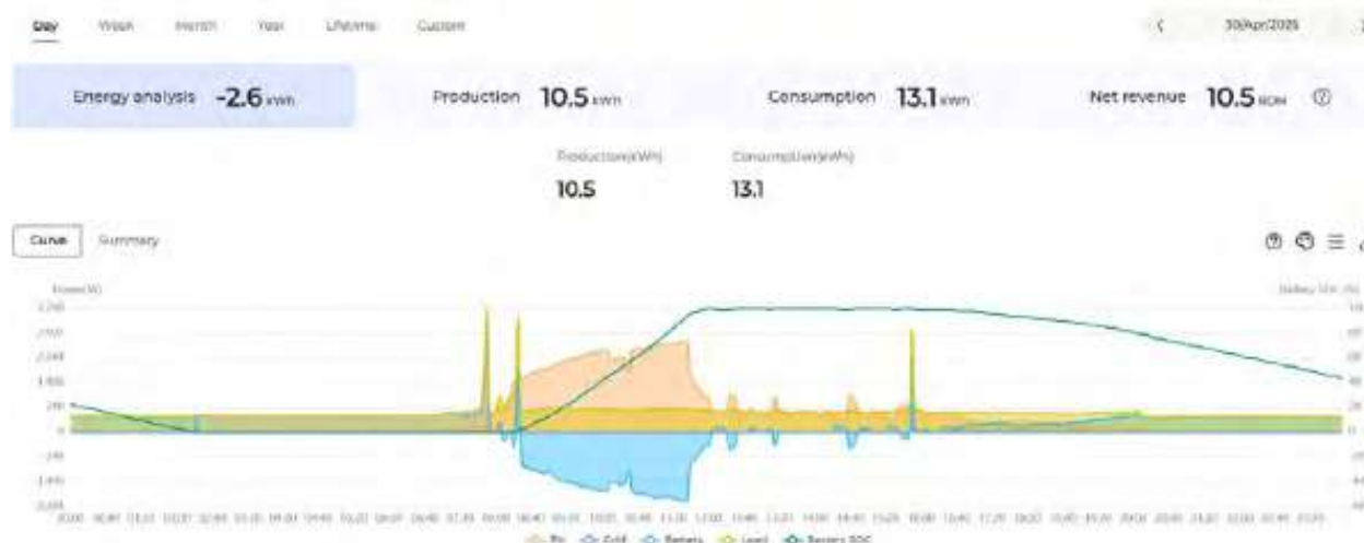
Figura 5. Analiza producției și consumului pentru ziua 30 aprilie 2025, folosind iSolarCloud.
