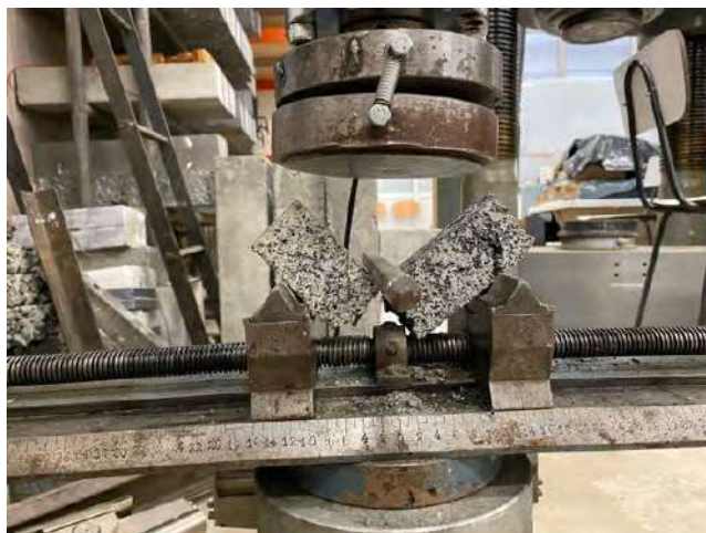
Figura 10. Încercarea betonului cu cauciuc la încovoiere
