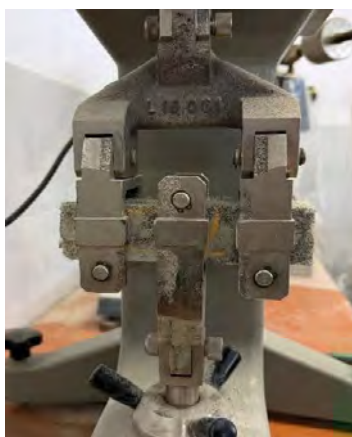
Figura 3. Încercare la încovoiere
