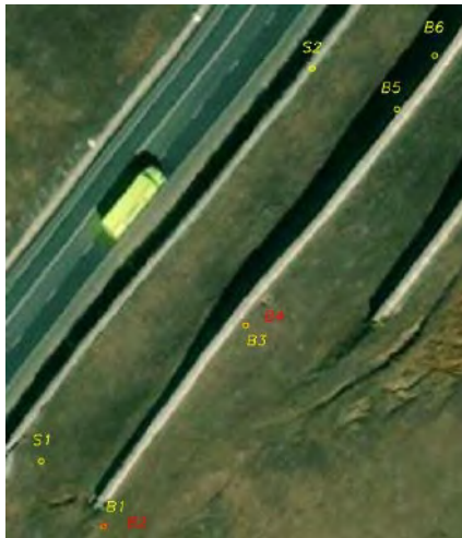
Figura 2. Amplasarea stațiilor în teren și a țintelor vizate (sursă proprie).
