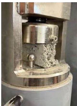
Figura 2. Încercare la compresiune
