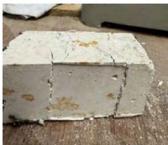
Figura 6. Comportamentul elastic al ipsosului cu 7% fibre textile sub solicitare de compresiune
