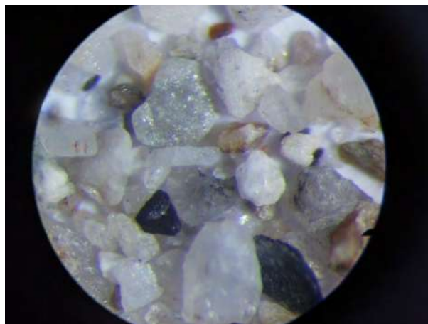
Fig. 4.2 Microfotografii ale compoziției mineralogice a nisipurilor (granoclastelor) din groapa de pietriș Sărdănești
