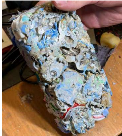
Figura 1. Căramidă de PET după piroliză la temperatură joasă.
