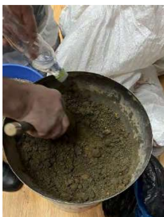
Figura 4. Omogenizarea amestecului după adăugarea apei
