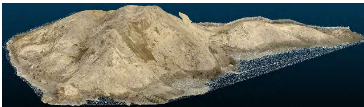
Figura 7. Norul de puncte obținut din scanarea cu iPhone 16 Pro (CloudCompare)
