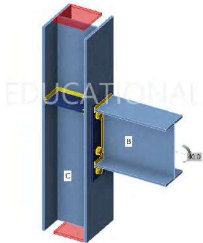
Figura 3. Îmbinarea N-rs în Idea StatiCa
