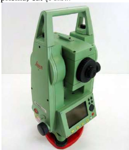
Figura 1. Stație Totală Leica TCR407, prismă mini , prismă standard.
