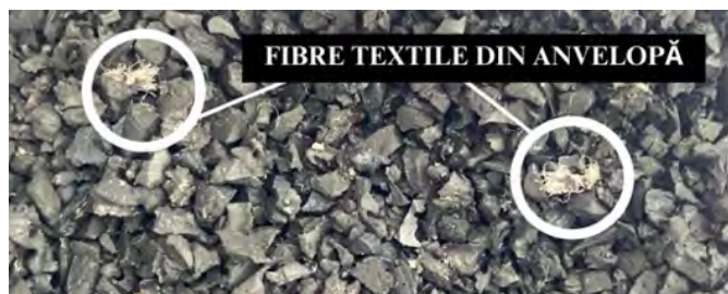
Figura 2. Fibre textile din cauciucul folosit
