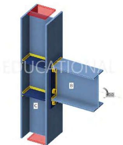
Figura 2. Îmbinarea N-roși în Idea StatiCa
