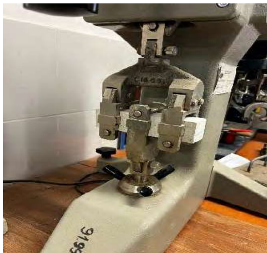
Figura 3. Mașina pentru încercare la încovoiere/tracțiune.
