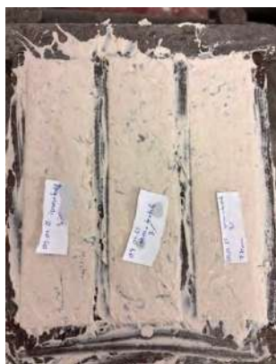
Figura 3. Probe cu 3% conținut fibre
