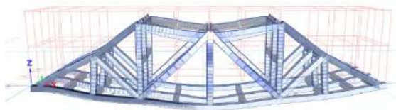
Figura 10. Forma deformată a Configurației 1.
