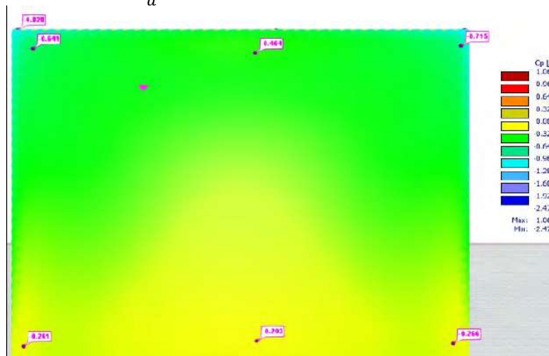
Figura 9. Variația coeficientului de presiune/sucțiune pe fața posterioară.
