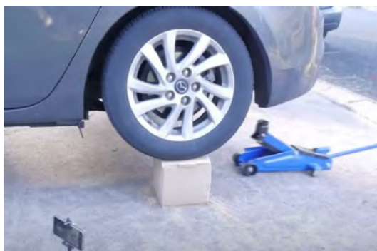
Figura 2. Cub din nisip armat ce susține o mașină.
