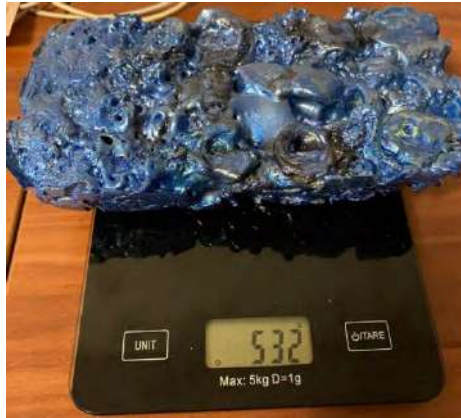
Figura 3. Cărămidă de PET după tratamentul termic și cântărită.
