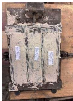
Figura 4. Probe cu 7% conținut fibre
