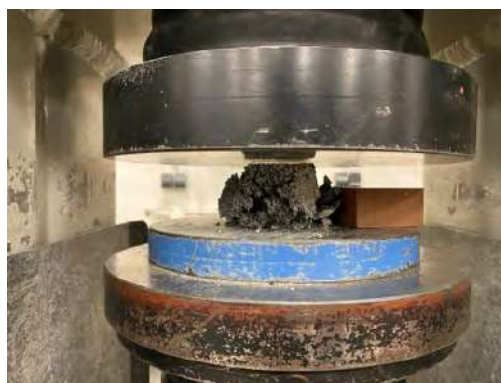
Figura 6. Încercarea betonului cu cauciuc la compresiune
