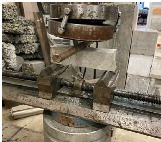
Figura 9. Încercarea betonului simplu la încovoiere
