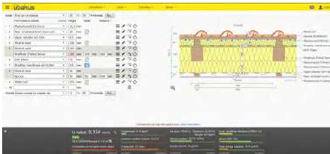
Fig 3.4.4 Simulare termică în Ubakus pentru Tigla metalică tip Bilka Această configurație obține valori tehnice comparabile, cu:
